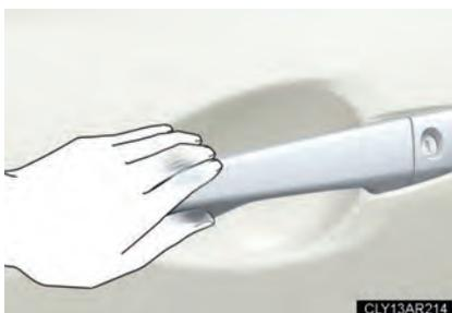
Toque simultaneamente nos sensores de travamento na parte superior e inferior da maçaneta da porta.
