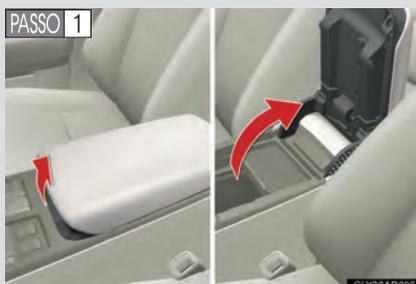
Puxe a alavanca para cima para destravar, e levante o descansab braço.
