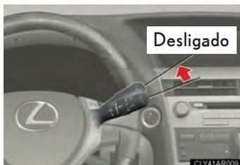
Ajuste a alavanca do limpador para a posição off. Caso a alavanca do limpador esteja posicionada em **AUTO**, os limpadores poderão funcionar inesperadamente nas situações abaixo, podendo prender suas mãos e causar ferimentos graves ou danos às palhetas do limpador.
