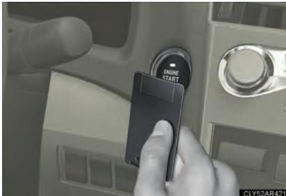
**PASSO 3** Pressione o botão de partida no período de 10 segundos após o alarme soar, mantendo o pedal de freio pressionado.
