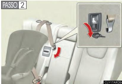
Abra a tampa do suporte de ancoragem, encaixe o gancho no suporte de ancoragem e aperte a cinta superior.
