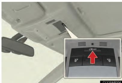
Desligue o botão de partida e pressione o botão de cancelamento do sensor de intrusão e sensor de inclinação.
