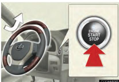
Quando o botão de partida for desligado, o volante de direção irá retornar à sua posição recolhida com movimento para cima e afastado para facilitar a entrada e a saída do motorista.
