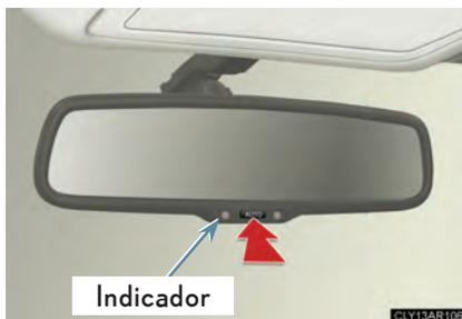
Alterar o modo automático da função antiofuscante
