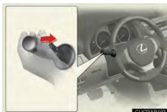
Desligue o motor com a alavanca de luzes em **AUTO** ou desligada, e puxe a alavanca em sua direção e solte-a. O fecho baixo dos faróis irá acender durante aproximadamente 30 segundos para iluminar a área próxima ao veículo.
