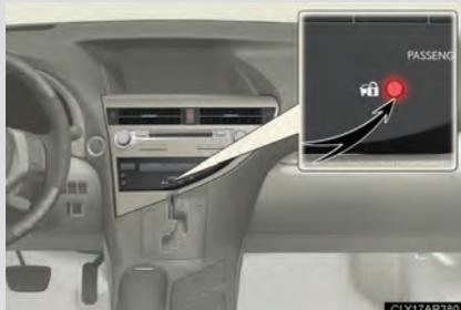
A luz indicadora irá piscar após o desligamento do botão de partida, indicando que o sistema está funcionando.
