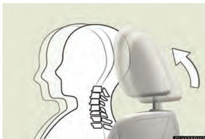
Quando a parte inferior das costas do ocupante é pressionada contra o encosto do banco durante uma colisão traseira, o apoio de cabeça move-se levemente para frente e para cima, para ajudar a reduzir o risco de lesões cervicais ao ocupante do banco.
