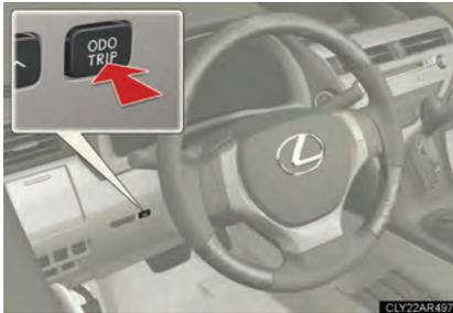
Comuta entre as indicações do hodômetro e hodômetro parcial. Pressionar e manter pressionado o botão durante a apresentação de alguma indicação do hodômetro parcial fará zerar o hodômetro parcial.
