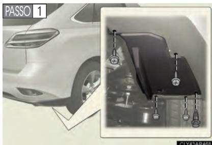
Remova os parafusos usando uma chave de fenda Phillips e remova a presilha.
