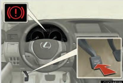
Para aplicar o freio de estacionamento, pressione totalmente o pedal do freio de estacionamento com seu pé esquerdo enquanto pressiona o pedal de freio com seu pé direito.
