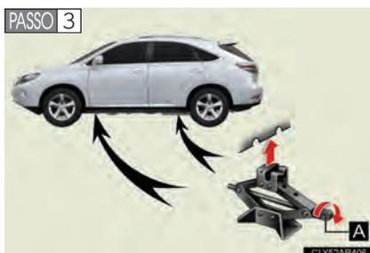
Manualmente, gire a parte “A” do macaco, até que o encaixe do macaco faça contato no ponto de levantamento.
